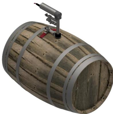
Il dispositivo manuale BRA Reference per la pulizia dei fusti nel luogo di stoccaggio con azionamento elettrico è composto da una testa di pulizia, un motore elettrico e un tubo di collegamento.
